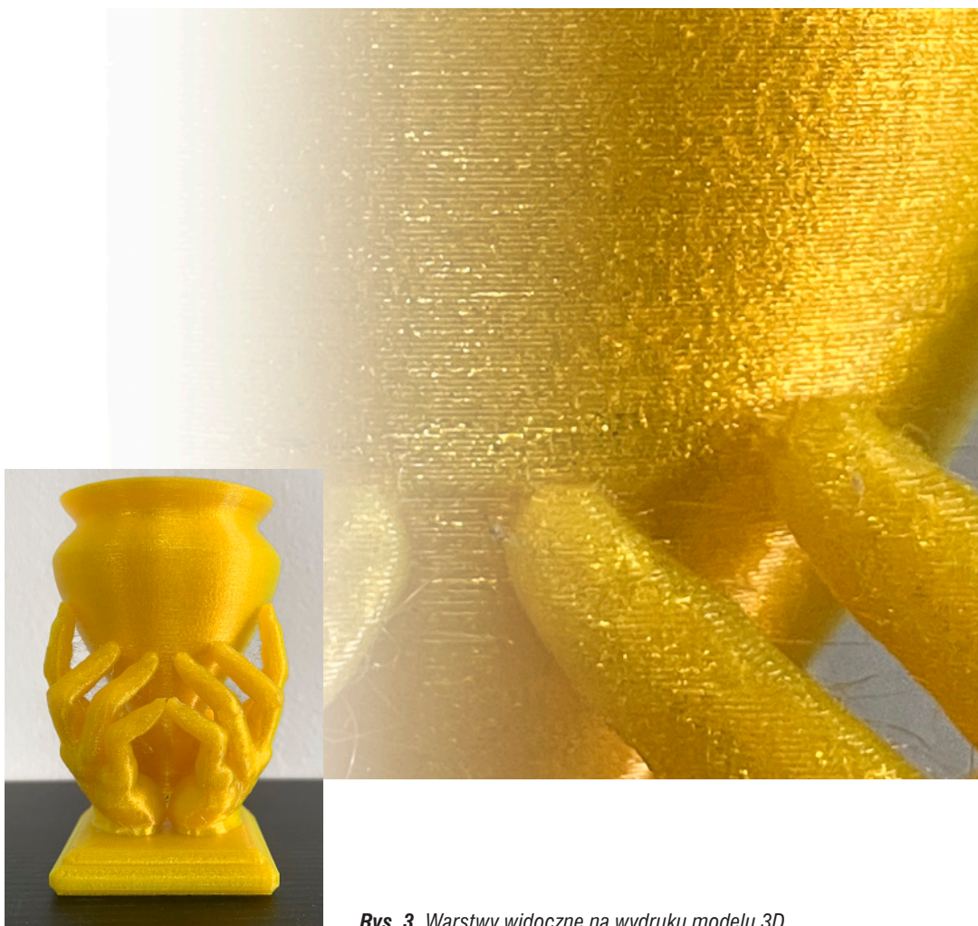
Rys. 3. Warstwy widoczne na wydruku modelu 3D
